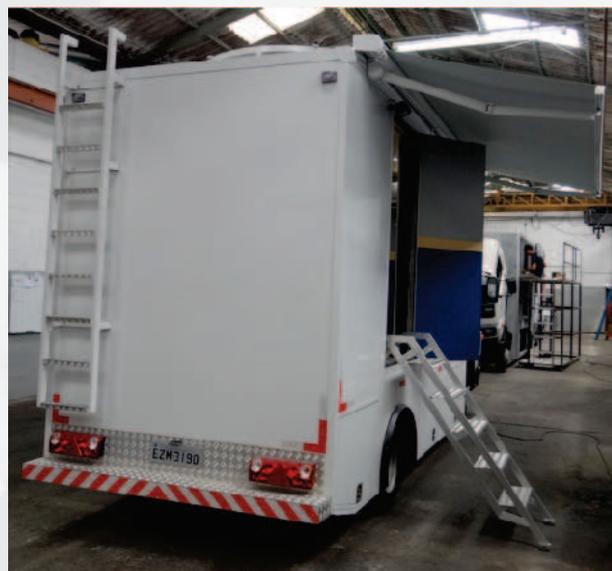
Ítems importantes, tais como, toldos laterais, escadas basculantes (tipo avião), portas internas de operação, podem ser adicionadas a qualquer projeto ou desenvolvidas e fabricadas conforme determinação do cliente e de sua engenharia.
